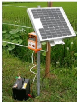
パワーユニットが効率の高い回路を使用しているため、小さなソーラーパネルで済みコストがかかりません。自動的にバッテリーに電気を送り充電するため、管理が楽になります。また、太陽光発電を行うため環境にも優しいシステムです。
