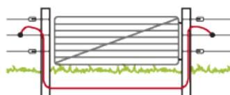
パワーユニットの強い電気をフェンスに送るための専用ケーブルです。ガラガー社のケーブルは抵抗が少なく、また磨耗に強い素材で被覆されており、安心してお使いいただけます。ゲート部の地下埋設にも使用します。
